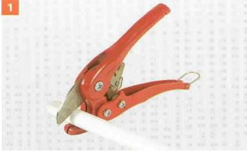
1. Das HAKATHEN- Metallverbundrohr mit der Rohrschere (ab Nennweite 26 mm mit Rohrschneider) rechtwinklig ablängen.
