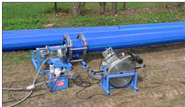
4.25 Serviceleistung von Gerodur: projektbezogene Beistellung von Spannbacken für Heizelement-Stumpfschweißung (Widos) – Lieferung in robuster Baustellen-Box
