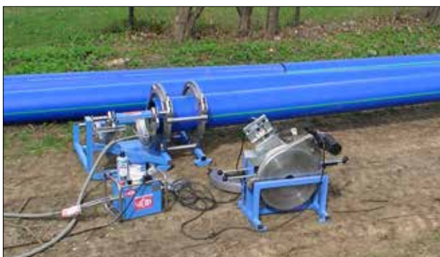
6.26 Serviceleistung von Gerodur: projektbezogene Beistellung von Spannbacken für Heizelement-Stumpfschweißung (Widos) – Lieferung in robuster Baustellen-Box
